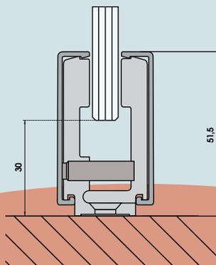
TOPVARIO: Querschnitt Klemmschiene
